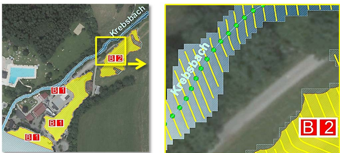
Abb. 64: Potenziell zu prüfende Ausström- und Druckbereiche mit Gefälle im Wasserspiegel. Auström- oder Druckbereiche (gelbe Fläche), Detektionsgraphen (gelbe Linien), Wasserspiegel (blau)
