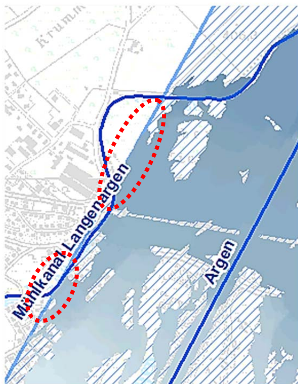
Abb. 35: Zu klein gewählter Modellbereich (rot) Beispiel 3 ■ Wasserspiegel ■ Modellbereich
