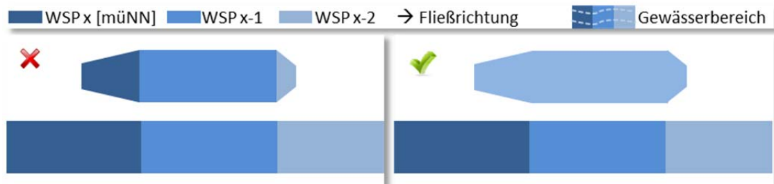
Abb. 22: Zuflusslose Senken bilden sogenannte Druckwasserbereiche (Ansicht von oben)
