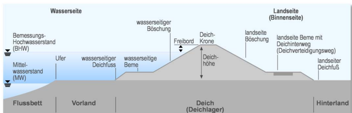
Abb. 11: Querschnitt durch einen Deich (Quelle: FAIGLE et al. 2007:5)
