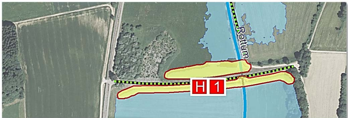
Abb. 74: Ergebnis der Fehlerkategorie H. Unstetiger Wasserspiegel (gelb) an einem Querbauwerk (grün)
