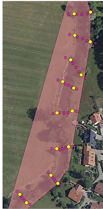
Abb. 59: Punkte zu Polygon Operation mit Convex Hull
