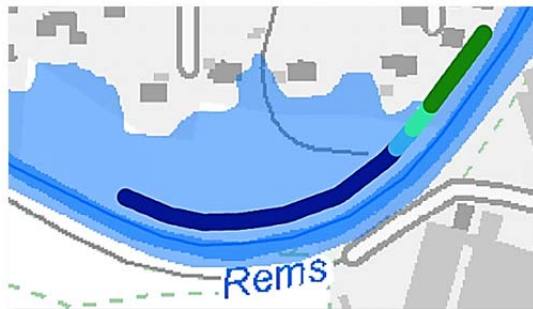
Abb. 71: (o.) Ausschnitt aus der Sicherheitsbetrachtung der HWGK. Die Klassifizierung zeigt den verbleibenden Freibord. Legende s. Tab. 11
