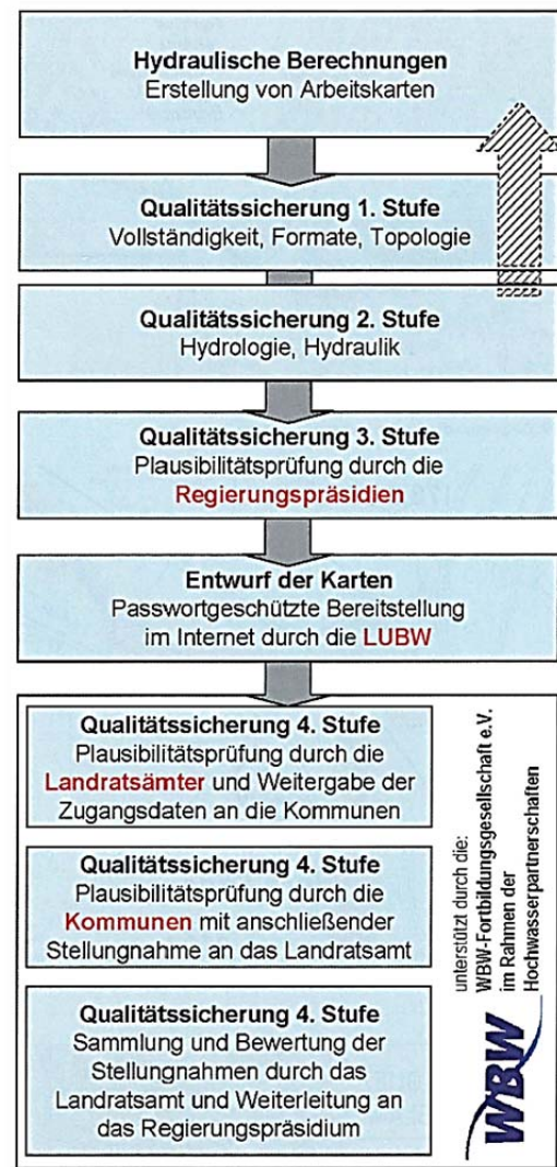
Abb. 6: Ablaufschema Qualitätsmanagement Hydraulik der HWGK(Quelle: ZEISLER 2008:31)
