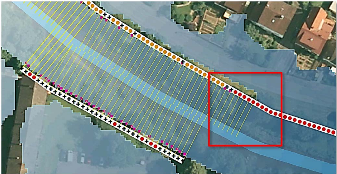
Abb. 69: (o.) Ergebnisdarstellung der Freibordbetrachtung in der Übersicht. Die Abbildung zeigt die Problematik des nicht erzielbaren Freibordstatus aufgrund der ESRI Operation „ExtractValuesToPoints“ (schwarzes „x“)
