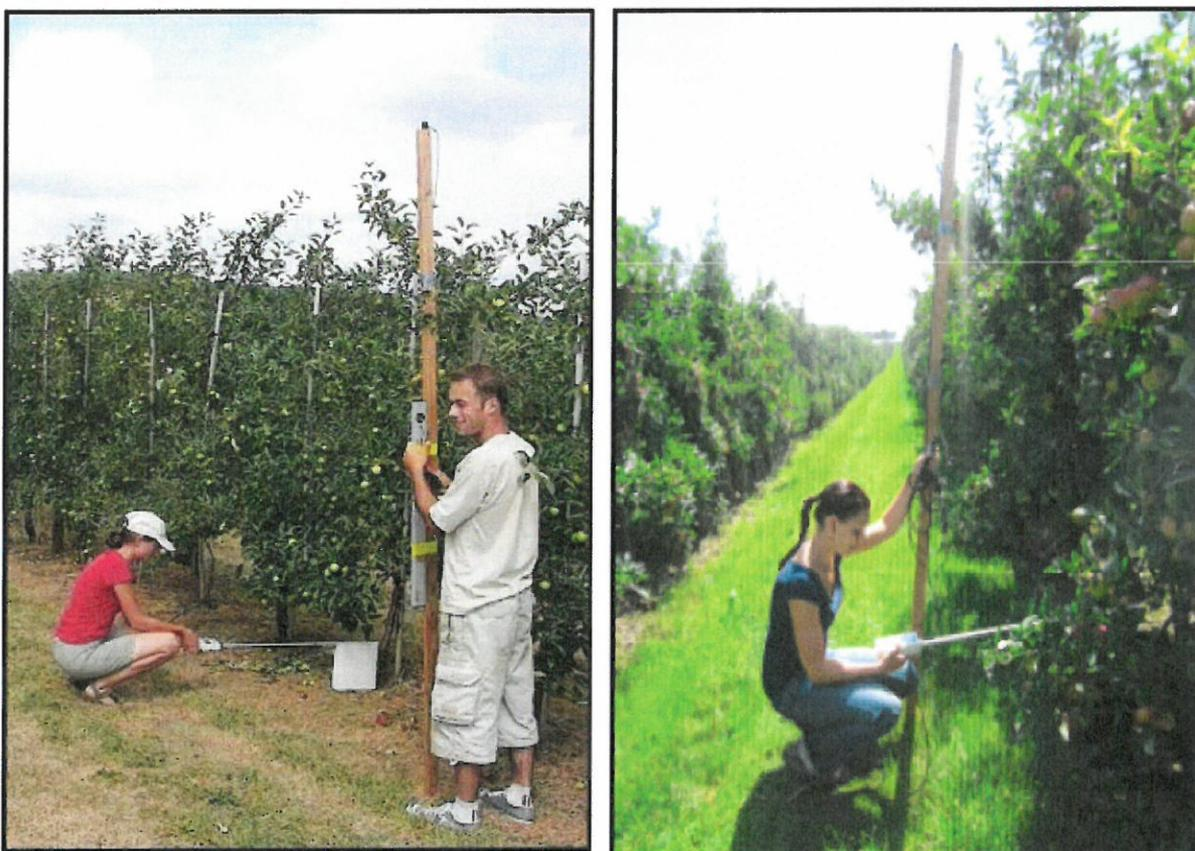
Abb. 2+3: PAR-Messungen im Feld - Top-Sensor auf Latte oben und Sensorstab
