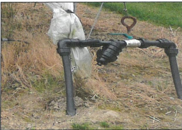
Abb. 7: Wasser-Zuleitung mit Ventil und Filter
