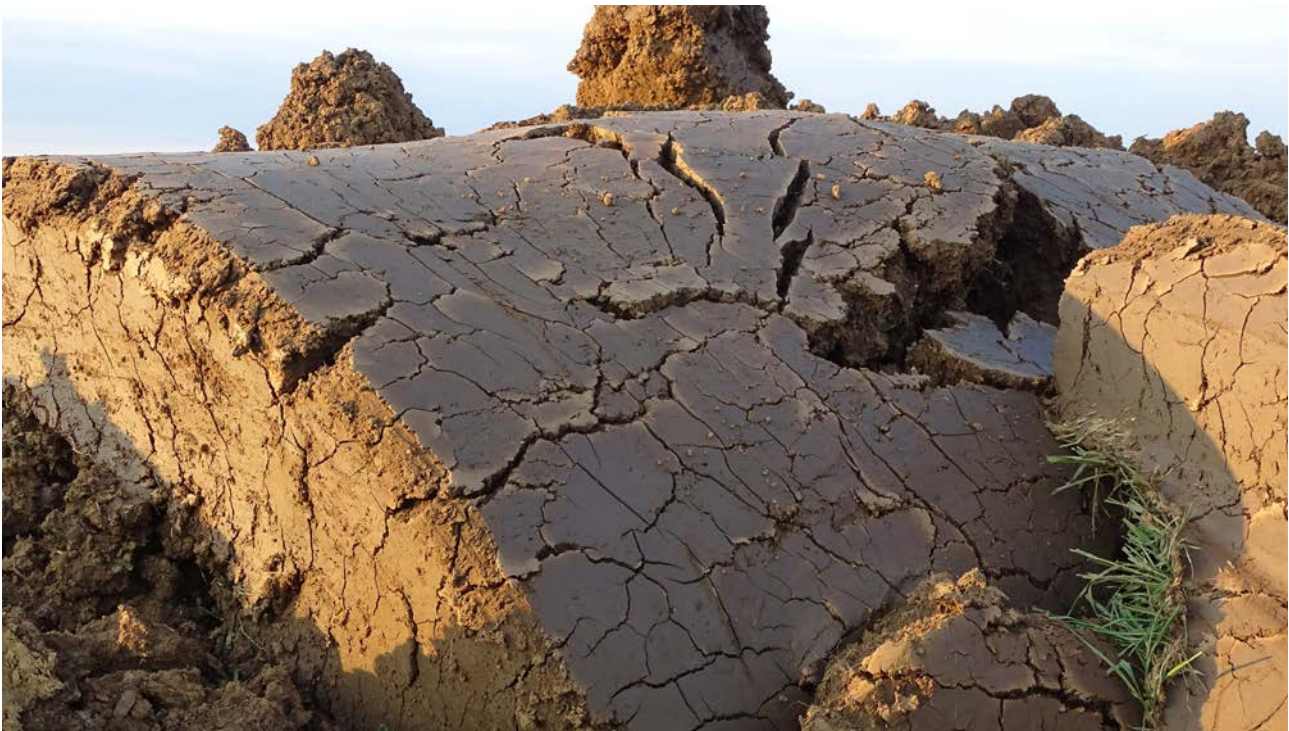
Abbildung 4.2: Walzenbildung und Gefügeschädigung durch schiebenden Abtrag bei Nässe
