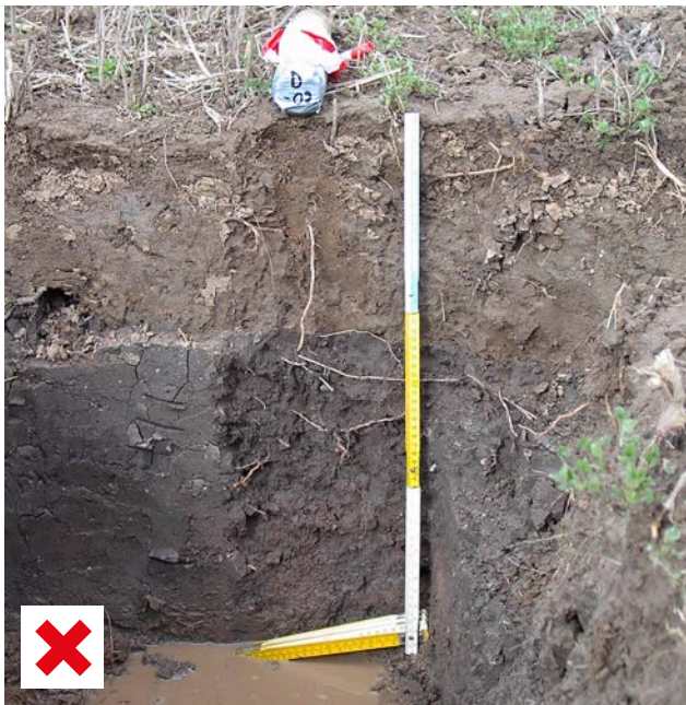
Abbildung 5.1: Schlechte Durchwurzelung infolge fehlender Verzahnung des aufgetragenen Oberbodens mit dem anstehenden und verdichteten Unterboden.
