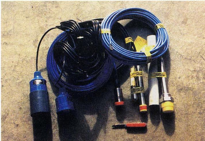
Bild 4: Gebräuchliche Wasserstandssonden. Rechts eine Einschraubsonde und zwei Eintauchsonden mit kapazitivem Aufnehmer. In der Mitte Eintauchsonde mit Dehnmeßbrücke auf Keramikmembran. Links zwei Ultraschallmeßköpfe.
