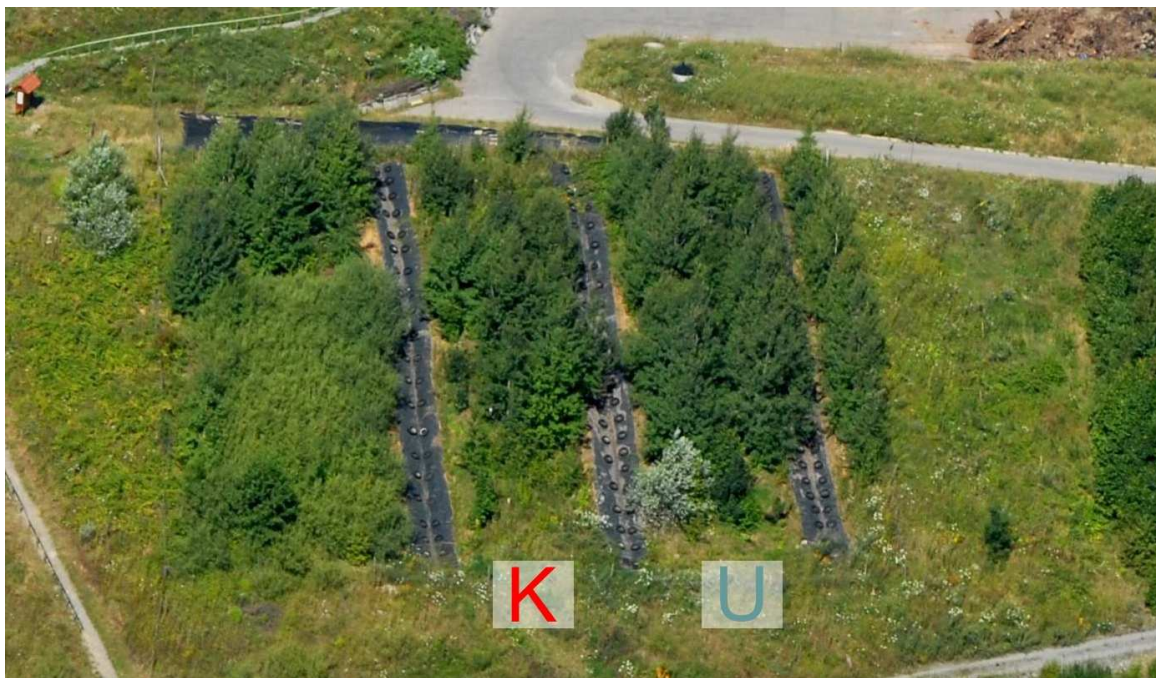
Bild 19: Luftaufnahme der Versuchsanlage im Sommer 2009; von links: Feld mit Buschlagen, Lysimeterfeld K (Boden verdichtet), Lysimeterfeld U (Boden unverdichtet)
