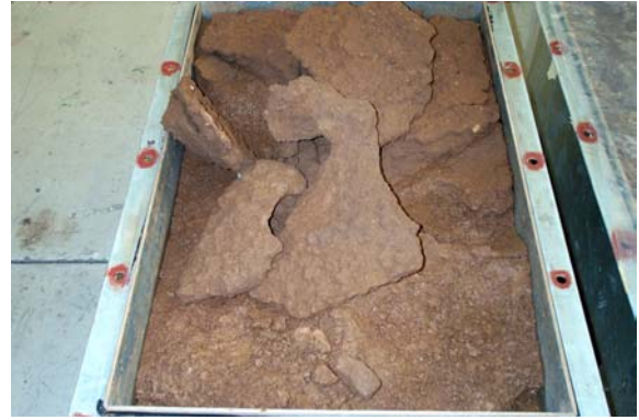
Abb. 54: Unbehandelter Lösslehm mit Schrumpfrissen vor und nach dem Überströmen
