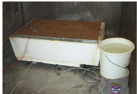
Abb. 57: Modifizierter Versuchskasten für die Frost-Tau-Wechsel in der Klimakammer
