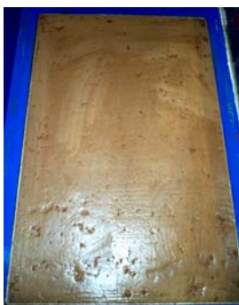
Abb. 52: Zeitliche Entwicklung der Oberflächenerosion bei Lösslehm im Versuch
