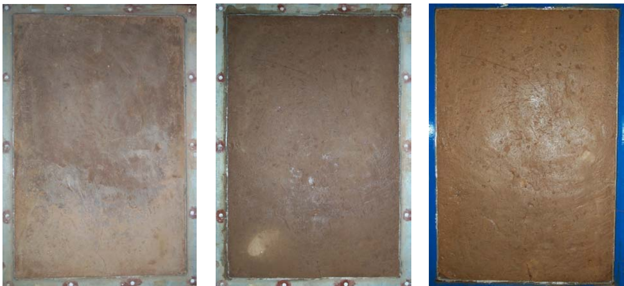
Abb. 56: Lösslehm + 6 Gew.-% DOROSOL C50: vor und nach den Frost-Tau-Wechseln sowie nach anschließender mehrstündiger Überströmung
