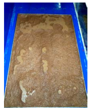
Abb. 52: Zeitliche Entwicklung der Oberflächenerosion bei Lösslehm im Versuch
