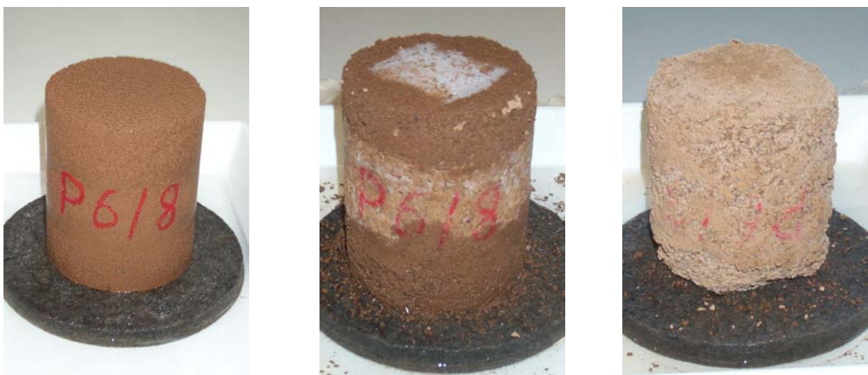
Abb. 59: 7 Tage alte, kalkstabilisierte Probe vor sowie nach 3 und 6 Frost-Tauwechsellern
