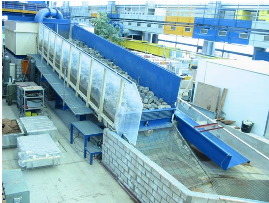
Abb. 10: Versuchsrinne für die großmaßstäblichen Modellversuche zu den Steinschüttungen
