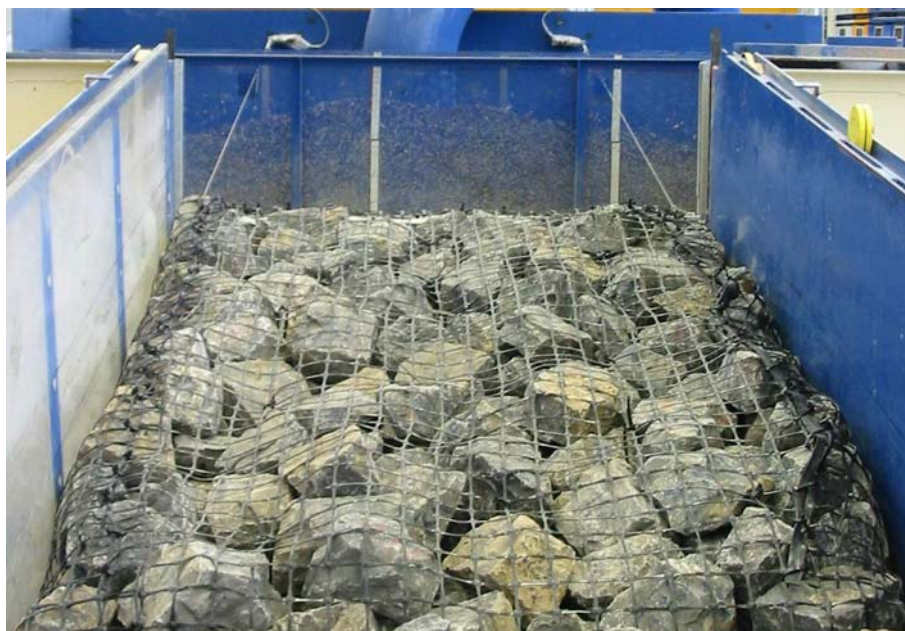
Abb. 34: Geogitterummantelte Steinmatratze mit den zwei Zugseilen
