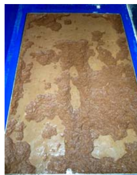
Abb. 52: Zeitliche Entwicklung der Oberflächenerosion bei Lösslehm im Versuch
