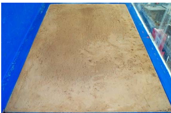
Abb. 55: Kalkstabilisierter Lösslehm vor und nach dem mehrstündigen Überströmen
