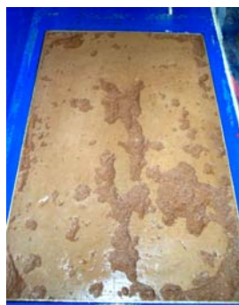
Abb. 52: Zeitliche Entwicklung der Oberflächenerosion bei Lösslehm im Versuch
