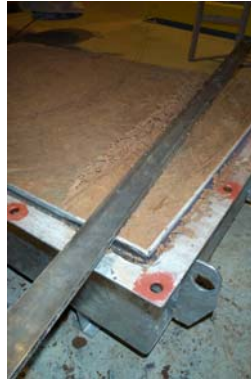
Abb. 51: Herstellung der Proben für die Erosionsversuche
