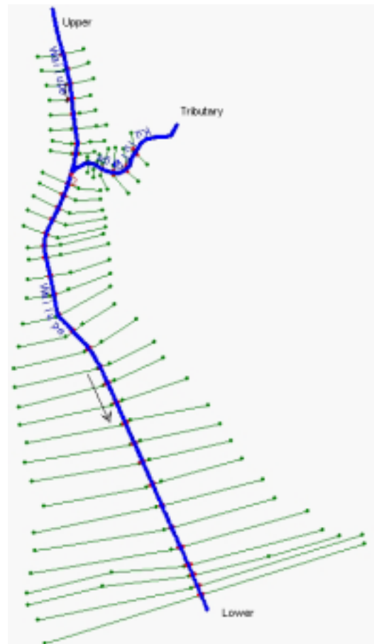
Abb.7.4: Darstellung des aus den DGM-Daten erzeugten 1D-Modells perspektivisch (oben) und als Draufsicht im Ansichtsfenster des HN-Programms (unten).
