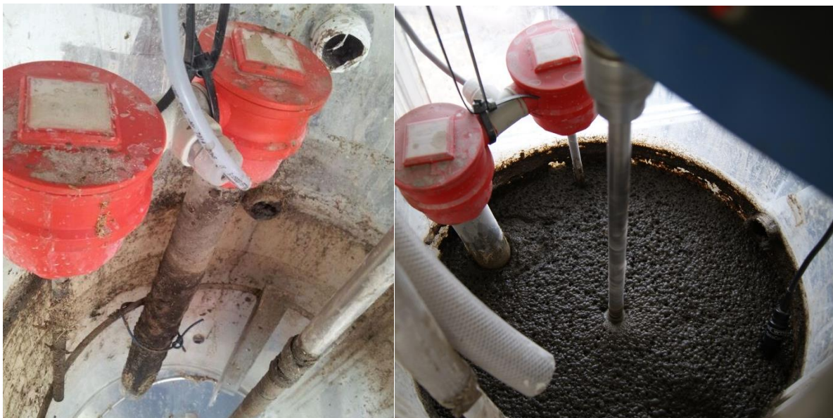
Abbildung 74: Tauchsieder zum Erwärmen der Gülle in den Reaktoren der Halbtechnikanlage
