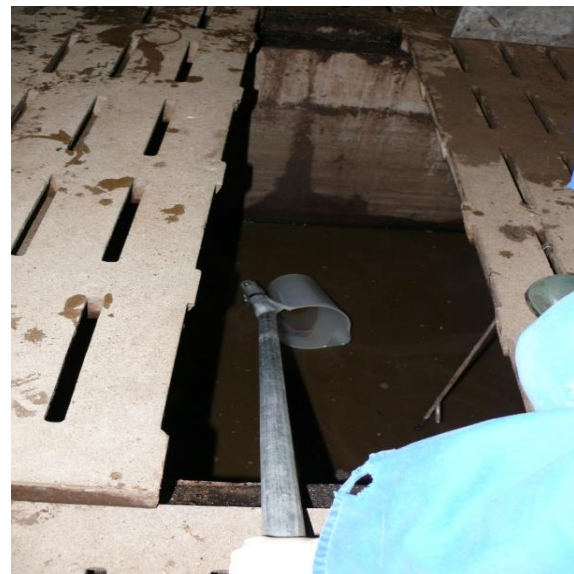
Abbildung 57: Geöffneter Spaltenboden mit Beprobungsvorrichtung
