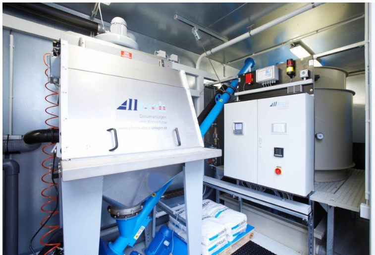
Abbildung 76: Demonstrationsanlage zur Nährstoffrückgewinnung aus Gülle am Standort Boxberg
