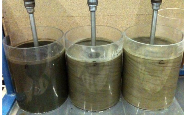
Abbildung 16: Rührbehälter mit Gülle bei laufendem Laborversuch
