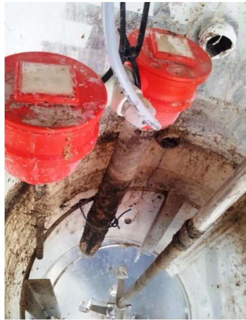
Abbildung 42: Tauchsieder im Reaktionsbehälter
