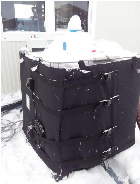
Abbildung 41: IBC-Container mit Thermohaube als Frostschutz
