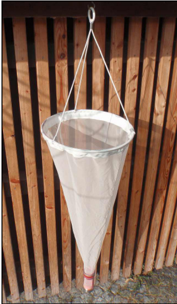
Abbildung 14: Planktonnetz (L 95 cm; D 40 cm, Maschenweite 100 \mu m).
