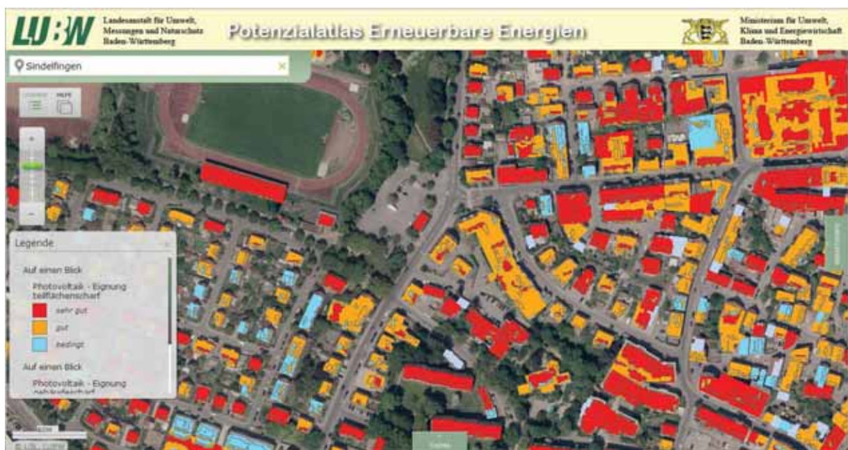
Abb. 1.3-8: Darstellung der für Photovoltaik geeigneten Dachflächen im Potenzialatlas Erneuerbare Energien Baden-Württemberg.
