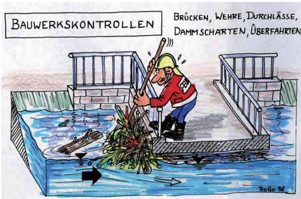
Abb. 5.7: Bauwerkskontrollen zur Freihaltung des Abflussquerschnittes
