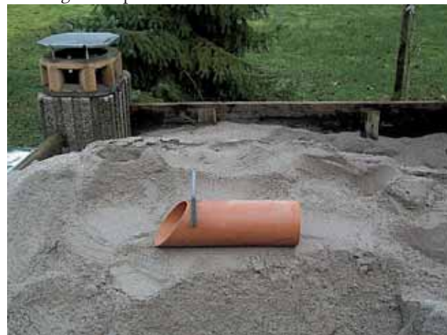
Abb. 5.1: „Sandschaufel“ zur Füllung von Sandsäcken (Eigenentwicklung einer Feuerwehr).
