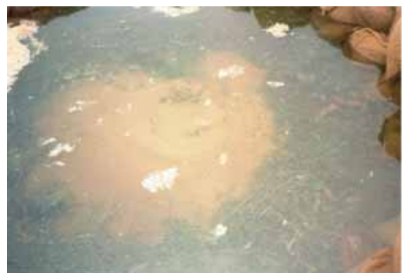
Abb. 4.13: Ausgetragenes Material in einem lokalen Notdeich
