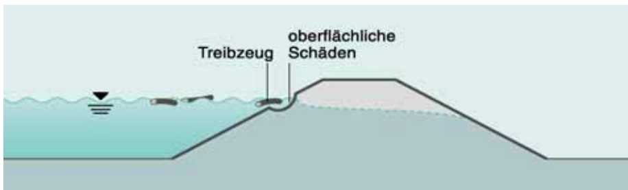
Abb. 4.22: Oberflächige Beschädigung der wasserseitigen Böschung
