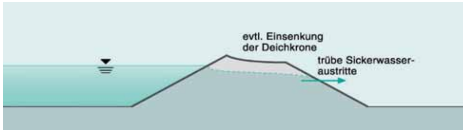
Abb. 4.10: Punktueller Austritt von trübem Sickerwasser
