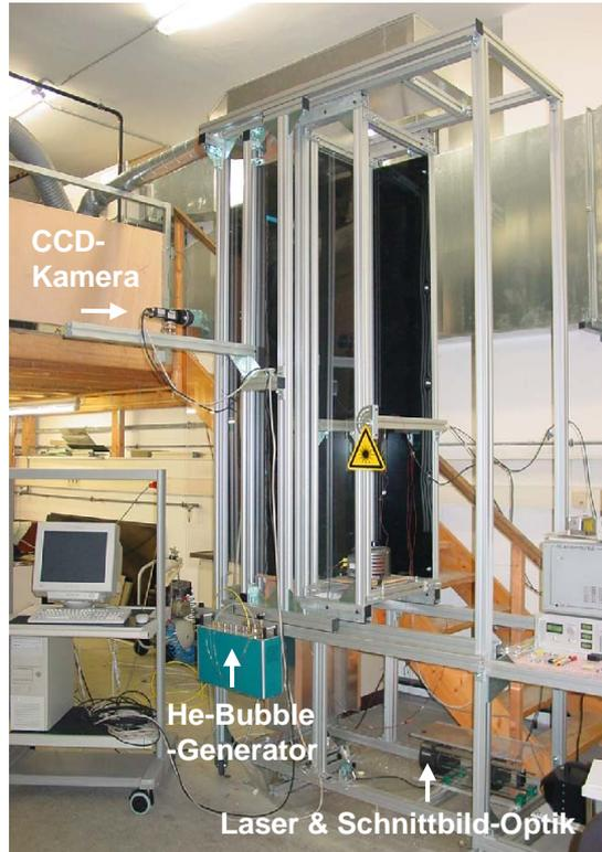
Abb. 1: Versuchsstand zur Visualisierung der Strömungsvorgänge innerhalb von Doppelfassaden
