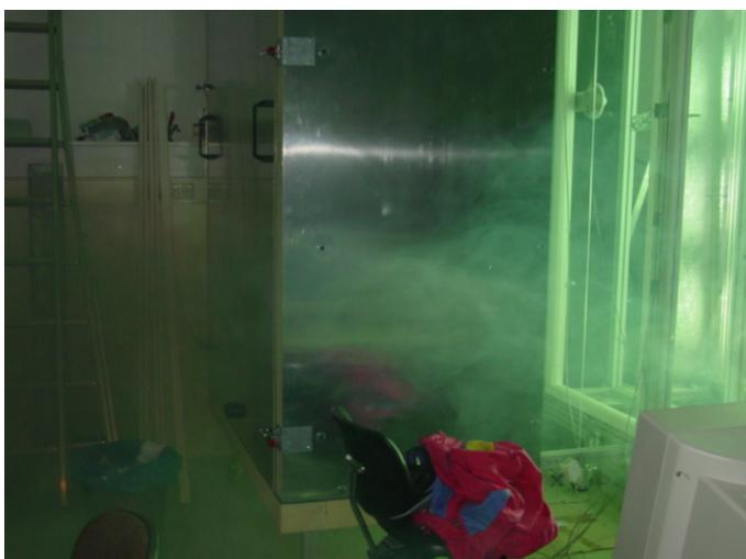
Abb. 19: Sichtbarmachung der Strömung mit Nebelgenerator
