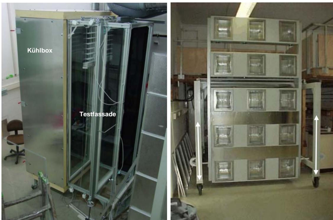
Abb. 51: Sonnensimulator, Testfassade mit Kühlbox
