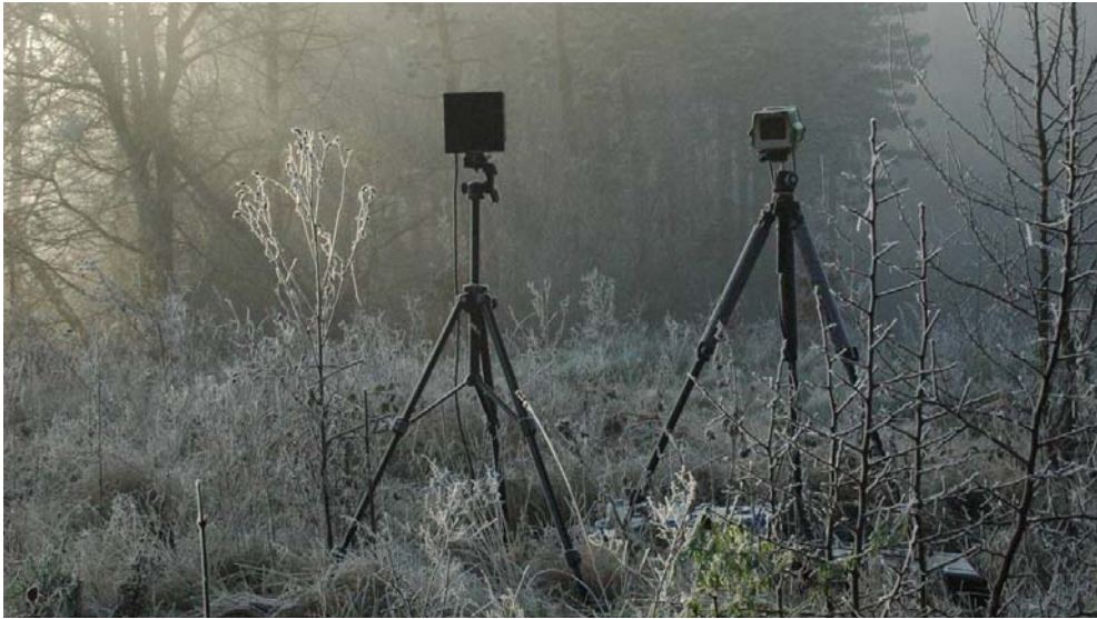
Abb. 4-7: Mit nachtsichttauglichen Infrarotkameras können Ausschnitte innerhalb der Wechselbereiche der elektronischen Wildwarnanlagen zusätzlich kontrolliert werden. Die Kameras werden auf die bevorzugt genutzten Wechsel ausgerichtet, da nur mit den Kameras die jeweilige Tierart festgestellt werden kann.
