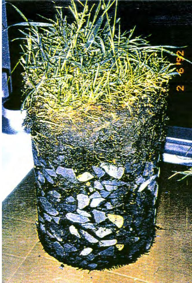
**Bild 8.1:** Bohrkern aus einer begrüntem Mastix-Schotter-Fläche (aus ELSKENS 1995)
