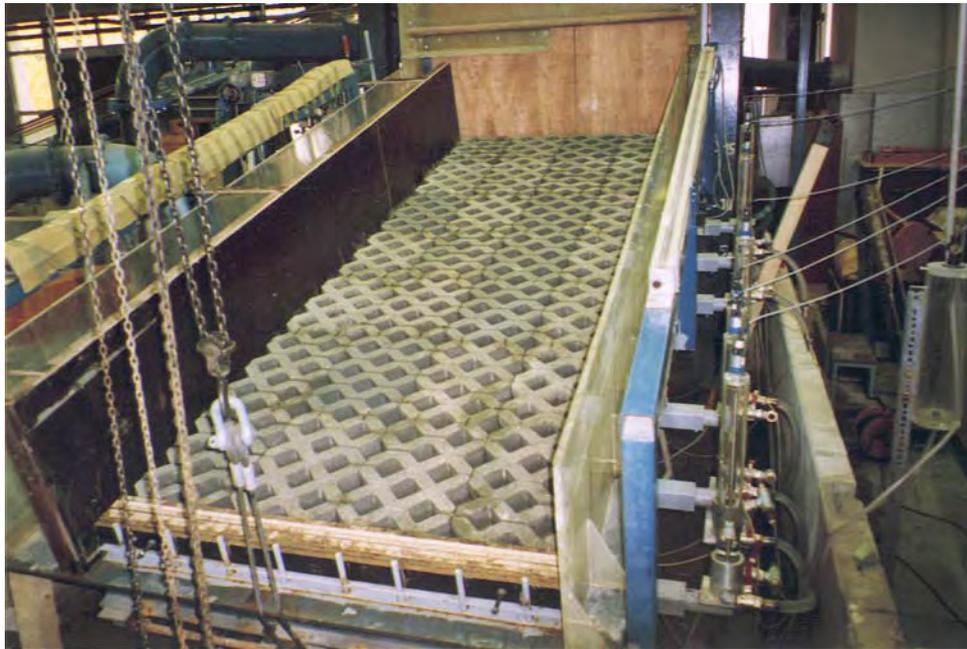
**Bild 7.3:** Kiprinne im Theodor-Rehbock-Laboratorium (hier mit Deckwerk aus ungefüllten Rasengittersteinen)
