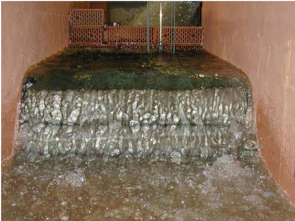
**Bild 10.32:** Überströmungsversuch eines Verbundsystems aus drei Gewebeschläuchen (Höhe ca. 35 cm) bei einer spezifischen Belastung von  $q_{\text{Modell}} = 140 \text{ l/(sm)}$  (entspricht  $q_{\text{Natur}} = 550 \text{ l/(sm)}$ )
