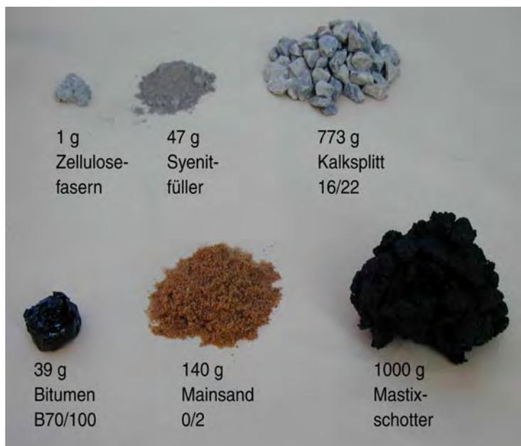
**Bild 9.3:** Bestandteile des Mastix-Schotters
