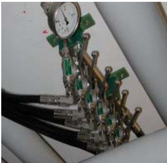
Abb.8 Druckluftregelung zur Ansteuerung einzelner oder mehrerer Düsen
