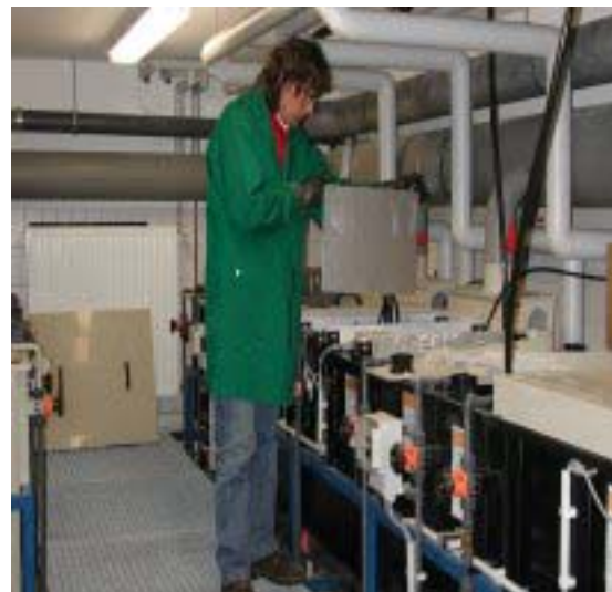
Abb.9 Anklemmen des zu anodisierenden Bauteils an die Anodenhalterung
