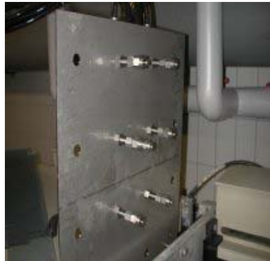
Abb.7 Sprühdüsenvariante mit V2A Grundplatte
