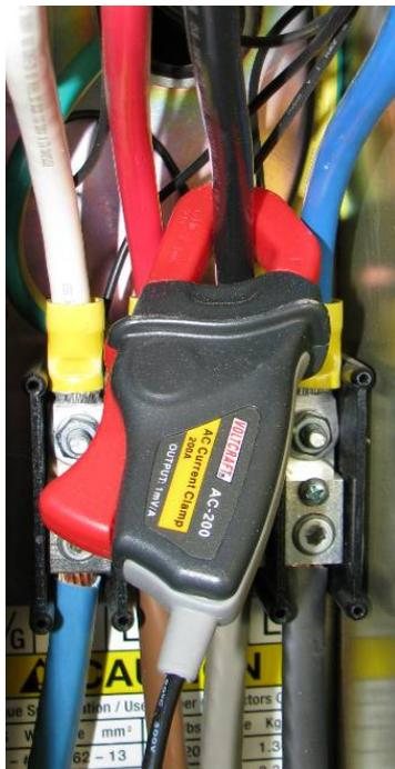
Bild 5.31 Zangenamperemeter an einer Stromader der Turbine
