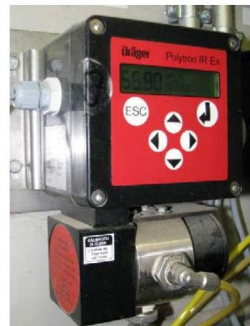
Bild 5.28 Dräger IR-Messgerät
