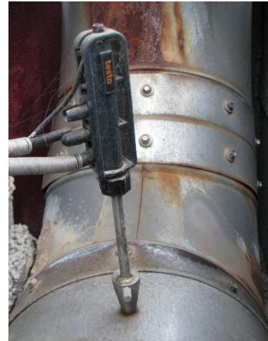
Bild 5.30 Abgasmesssonde
