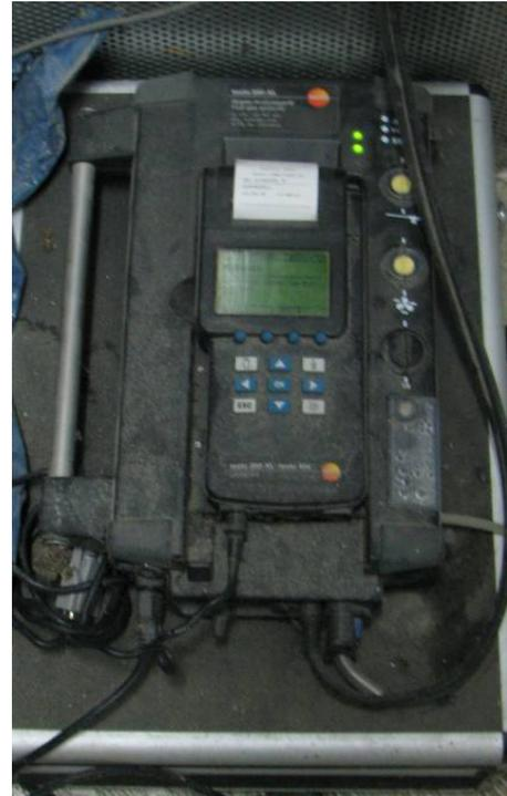
Bild 5.29 Abgasanalysegerät Testo 350XL
