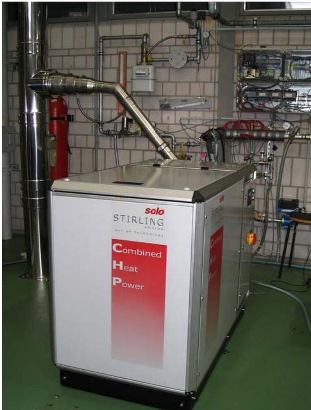
Bild 3.16 SOLO\_Stirling-BHKW am Prüfstand
