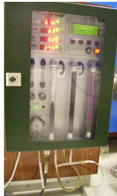
Bild 4.1 Brenngas-Analysegerät
