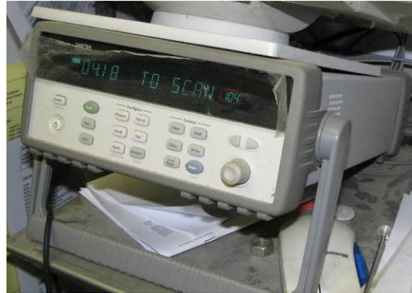
Bild 5.32 Datenlogger HP Agilent 34970A
