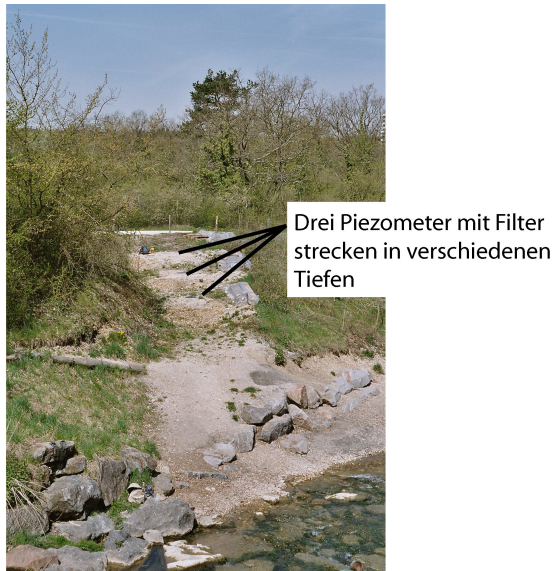
Abb. 1.8.8: Grundwasserbeobachtungsrohre zum Studium der Fluss-Grundwasser-Interaktionen entlang der Birs. Automatische Pegelmessungen, Temperatur und el. Leitfähigkeit, sowie Möglichkeit der Probenahme, Photo I. Spottke, GPI.
