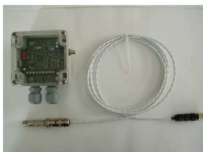
Abb. 104: Hitzdrahtanemometer von Seikom mit abgesetztem Fühler
