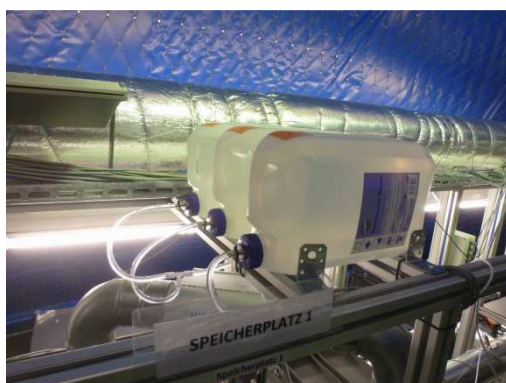
Abb. 126: Wasserreservoir für die Luftbefeuchtung (Kapazität: 15 ltr. destilliertes und demineralisiertes Wasser)
