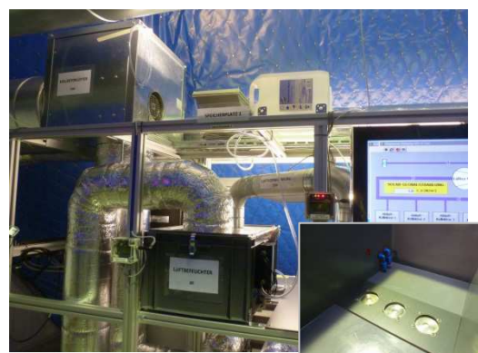
Abb. 127: Luftbefeuchtungssystem mit Luftbefeuchterbox, Wasserreservoir und optionaler Vorheizung
