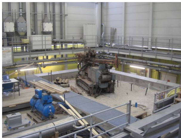
Abbildung 38 Bohrung und Einbau der EWS auf VEGAS Großbehälter
