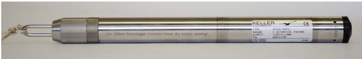
Abbildung 1 Druckaufnehmer mit Datenlogger zur kontinuierlichen Ermittlung von Piezometerhöhen in Beobachtungsbrunnen
