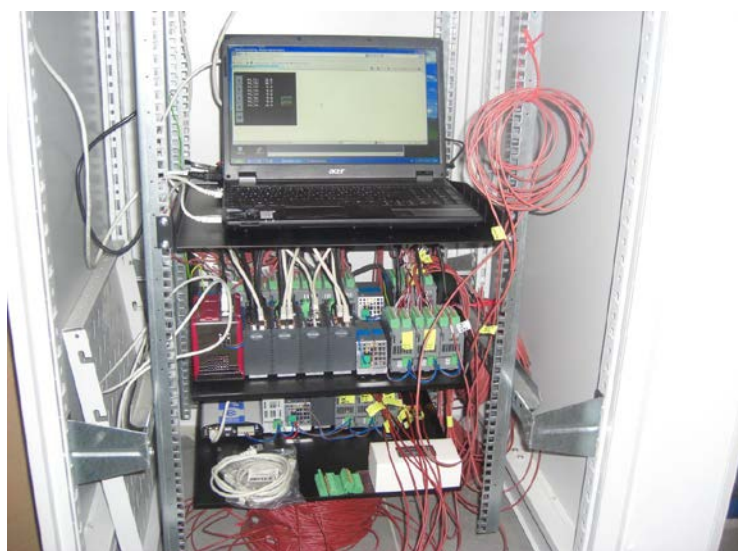
Abbildung 13 Datenerfassung zur Temperaturmessung in 4 Brunnen im Abstrom der EWS, einem Brunnen oberstrom, zwei Koaxialsonden, einer Helix, Zu- und Rücklauf der EWS und für den Wärmemengenzähler
