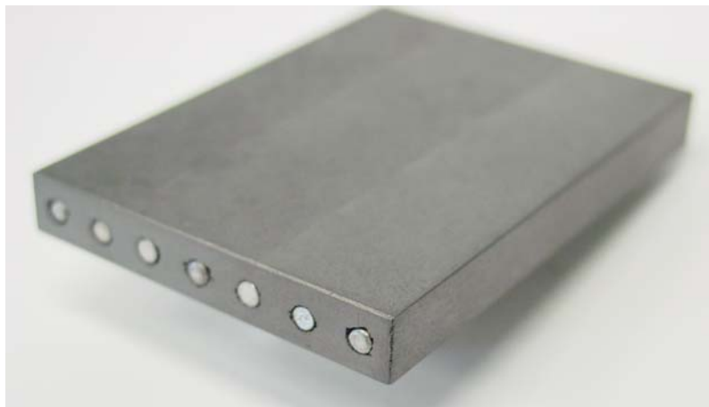
Abbildung 23: Graphit-Bipolarplatte mit integrierten runden Heatpipes
