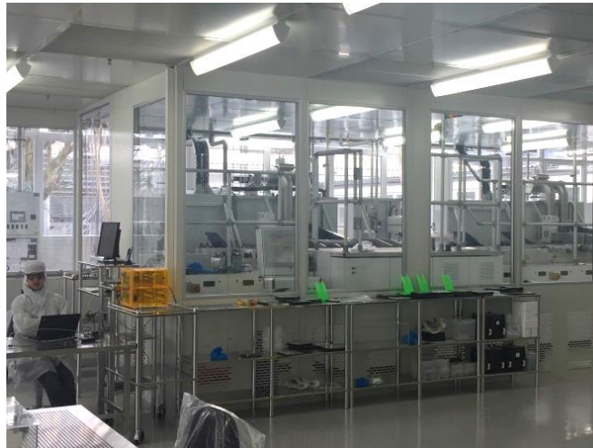
Abbildung 10: Integration einer großflächiger PECVD Beschichtungsanlage (MAiA).
