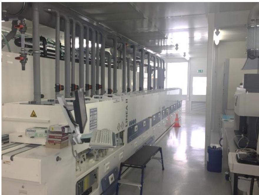
Abbildung 12: Integration einer Inline-Nasschemieanlage sowie entsprechender Spurenanalytik-Messtechnik (rechte Bildhälfte).
