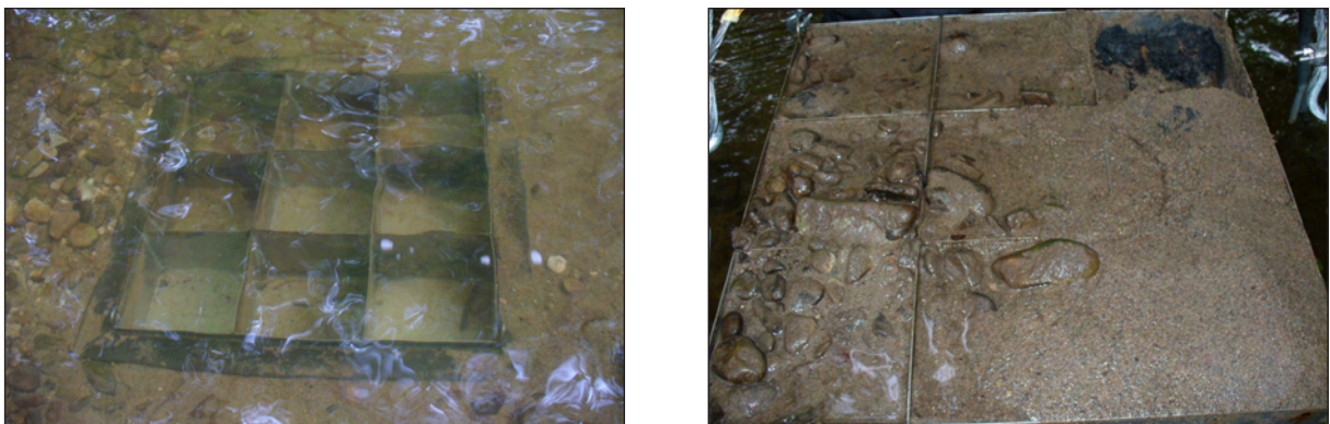
Abbildung 5.15: Eine der Geschiebefallen im frisch eingebauten Zustand (links) und während des Entleerens (rechts).
