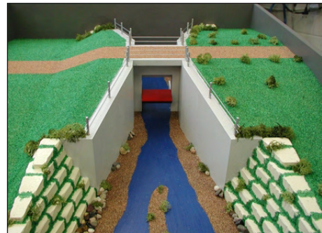
Abbildung 7.40: Modell eines ungesteuerten Beckens mit „Schwingklappe“ (Bild: Uni Karlsruhe, Institut für Wasser und Gewässerentwicklung)
