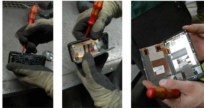
Abbildung 14: Abhebeln des geklickten und zusätzlich verklebten Touchscreens (links), dabei wird Touchscreen-Einheit beschädigt; Ablösen des Touchscreens (Mitte); Klebeverbindungen zwischen Touchscreen und verbleibendem Elektronikträger (rechts)
