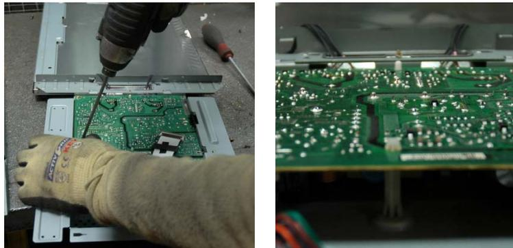
Abbildung 9: Entfernen der Netzteil-Leiterplatten (links); neben Verschraubung mit Kunststoffstiften gesichert, die beim Ablösen zerstört werden müssen (Mitte)
