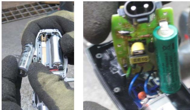
Abbildung 5: Gesteckte Akkumulatoren (links); verlöteter Akkumulator (rechts)
