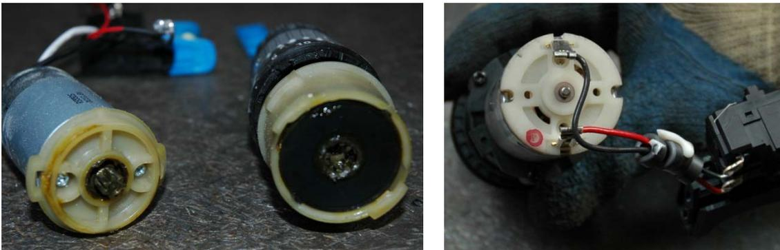
Abbildung 19: Motor durch Steckverbindung von Schraubkopf trennbar (links); Schalteinheit durch Steckverbindung von Motor trennbar (rechts)
