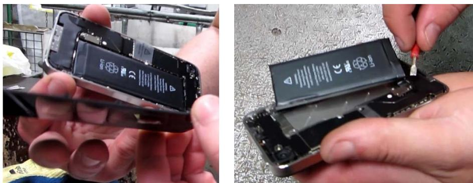
Abbildung 13: Abnehmen der Rückseite (links); Lösen des Akkumulators (fixiert mit Klebeverbindung), hier Lösen der Elektroniksteckverbindung (rechts)
