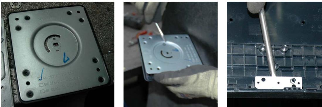
Abbildung 8: Konsole des Monitorfußes, Kunststoffplatte wärmebehandelt an Fe-Bauteil angebracht (links); beim Lösen wird die Verbindung am Kunststoffbauteil beschädigt (Mitte); Kunststoffverbindungen brechen beim Lösen der Stabilisatoren (rechts)
