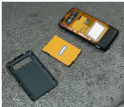
Abbildung 10: Entnahme des Akkumulators zerstörungsfrei ohne Werkzeug
