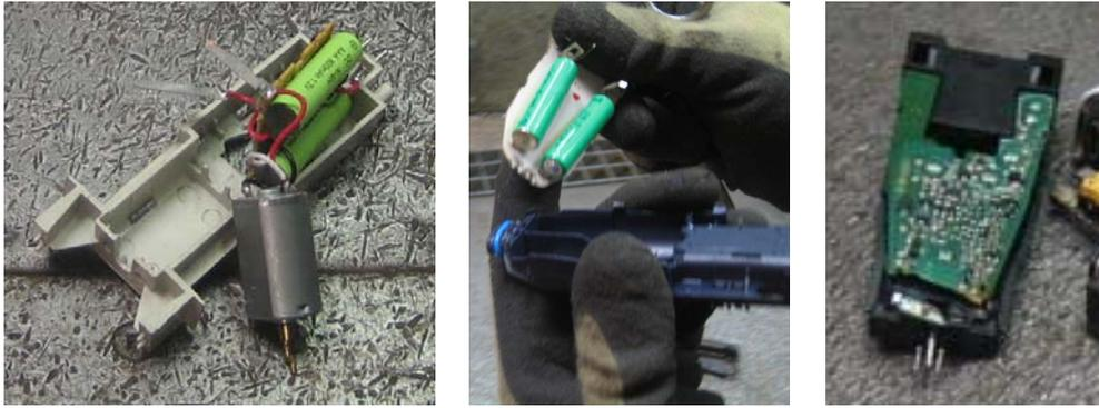
Abbildung 6: Eingelegter Motor mit gesteckten Kabelverbindungen (links); gesteckte Leiterplatte (Mitte); mit Trägerschale fest verbundene Leiterplatte (rechts)
