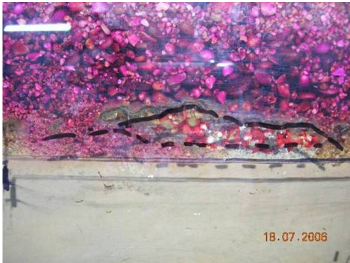
Abbildung 63 – Braunsteinbildung um CKW-Pool, Detail, Küvette
