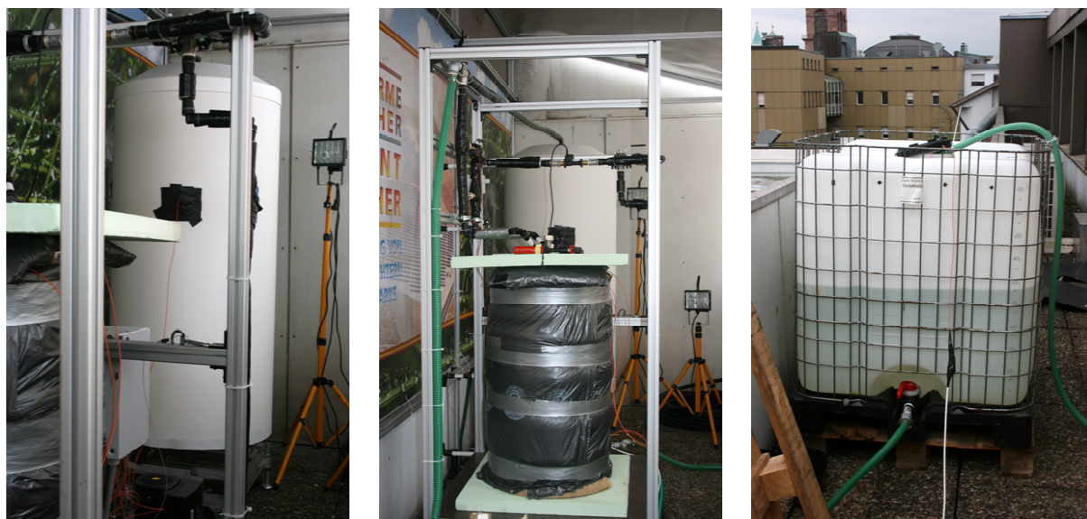
Abbildung 25: Boiler, Einzelspeichermodule mit Verrohrung und Auffangbehälter des Versuchsstandes
