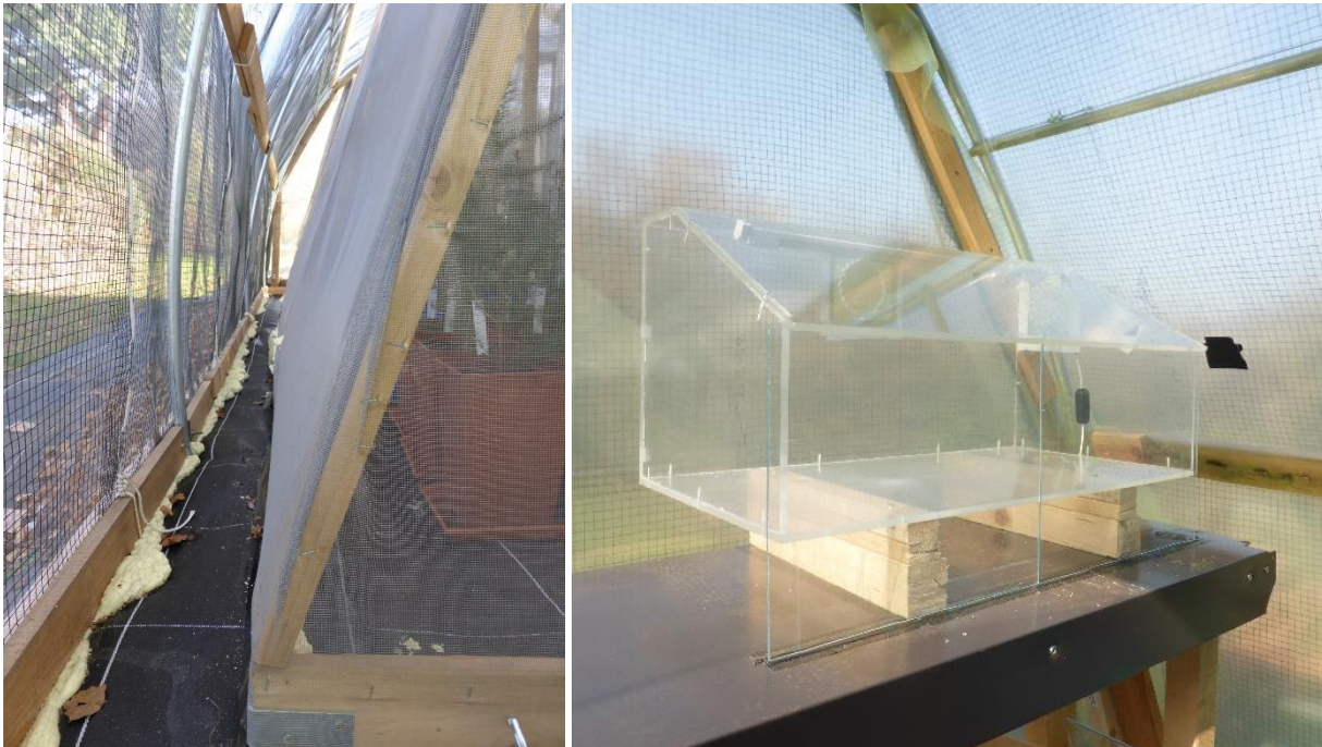
Abb. 3: Pufferzone zwischen internem Experimentier- und externem Schutzhaus (links) sowie windgeschützter Wiegebereich (rechts).
