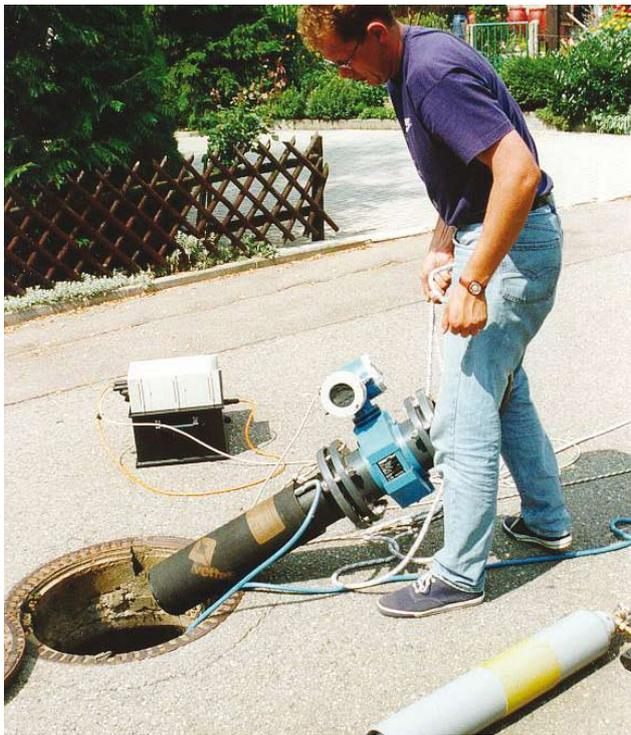
Abb. 5: Mobile magnetisch induktive Durchflussmessung (MID) mit Absperrblase (für kurz- und langfristige Messungen)<sup>2</sup> (Quelle: Axel Zangenberg)
