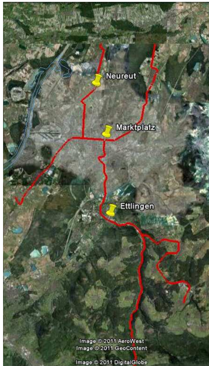
Abbildung 4.9: Zur Bestimmung von h_0 , p_0 , T_0 : An den markierten Orten Neureut, Marktplatz und Ettlingen ist die Höhe bekannt und wird als Ausgangshöhe benutzt.
