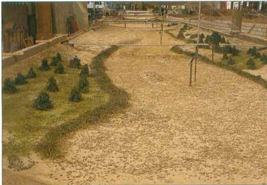
Der hydraulische Fließwiderstand wird im Modellversuch mit unbeweglichen Kieskörnern nachgebildet. So können naturähnliche Fließzustände erreicht werden. (Heger 1989).
