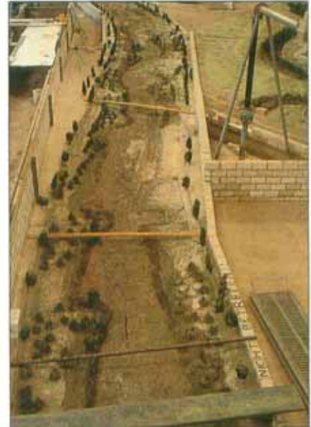
Modellversuch im Maßstab 1 : 40 am Institut für Wasserbau und Kulturtechnik, Universität Karlsruhe (Heger 1988).
