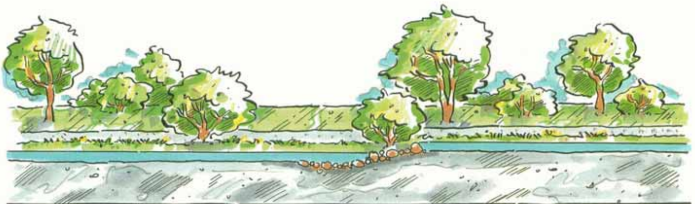
Abb. 15.2: Längsschnitt durch einen Absturz mit Tosbecken.
