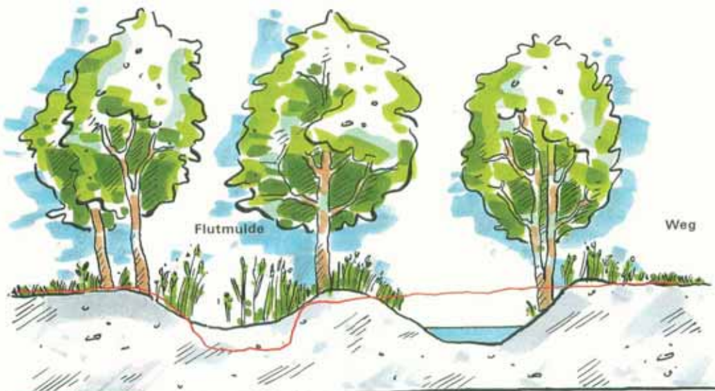
Abb. 2.7: Schnitt durch eine geplante Bachschlinge am Weißenhofbach
