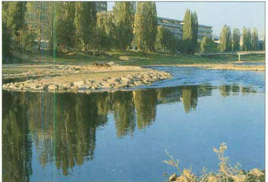
Die Engstellen und Aufweitungen sorgen für einen ständigen Wechsel von Beschleunigung und Verzögerung der Fließbewegungen (Bernhart 10/1990).
