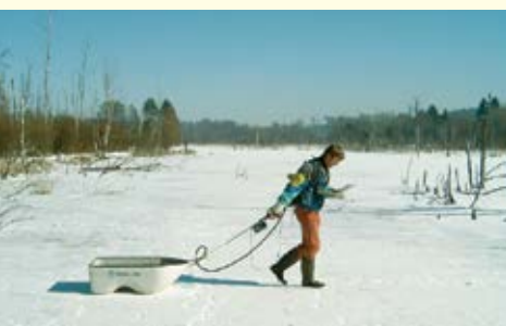
Georadar zur Bestimmung der Torfmächtigkeit, Auslesen der digitalen Wasserpegel mit Laptop und Moosmonitoring.
