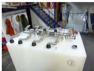
Abbildung 60: Übersicht verschiedener kommerzieller Latentwärmespeicherlösungen, oben Makrokapselsysteme, unten Systeme mit in das PCM eingetauchte Wärmeübertrager (engl. Immersed Heat Exchange)
