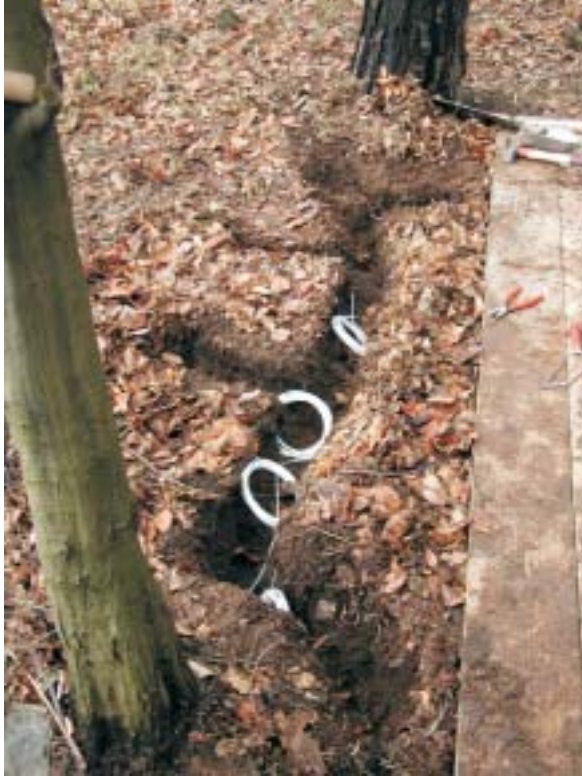
Abbildung 5.1-3 Einbau von Saugkerzen in 10 cm Tiefe an der Messstelle Forst
