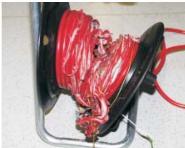
Abbildung 6.1-8 Leitungsroller nach dem Abwickeln
