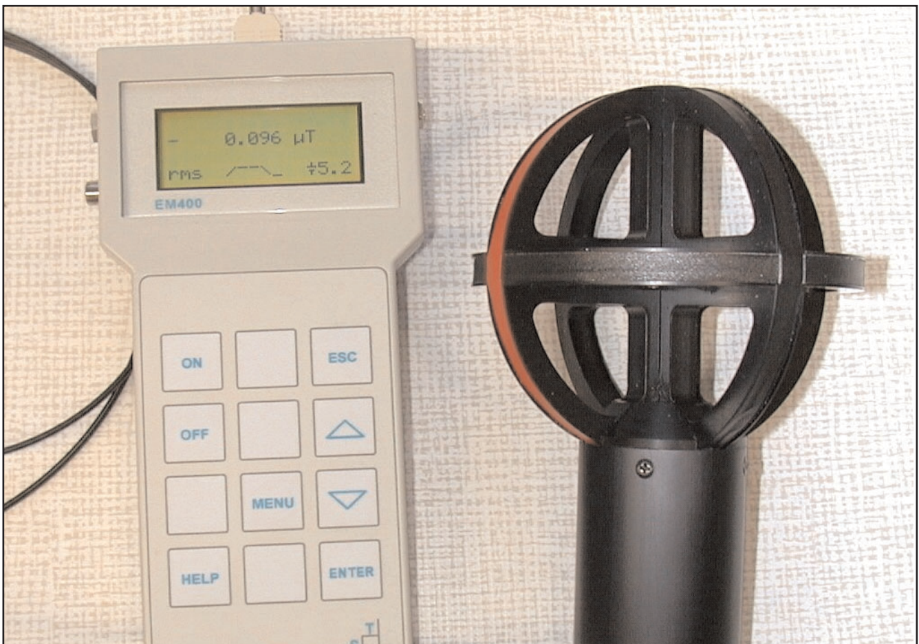
Abbildung 5: Messsystem zur automatischen Magnetfeldmessung
