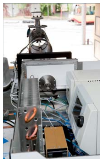
Die Messgeräte sind auf dem Dach der Straßenbahn angebracht; der Messeinlass und die Partikelanalytoren befinden sich an der Front (rechts) und die Gasphasen-Analysatoren sowie die Betriebstechnik in der Mitte (links).
