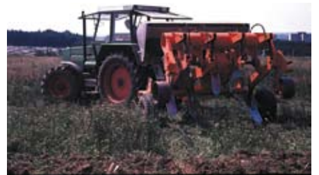
Einsatz eines Lockerungsgerätes
