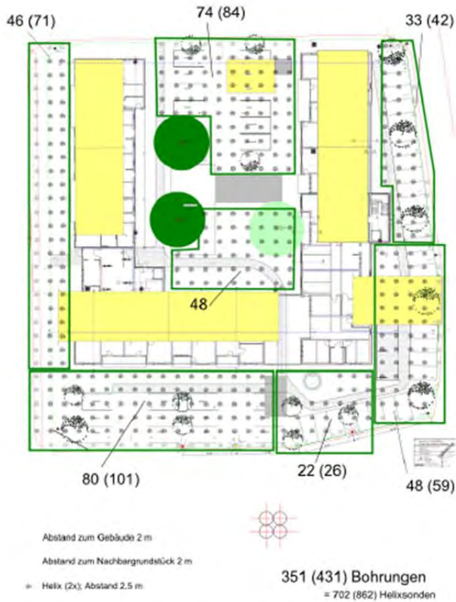
Abbildung 9: Erdsondenverlegung quadratisches Gitter (Quelle: ITW)
