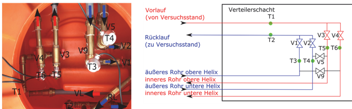
Abbildung 3.3: Aufbau des Verteilerschachts. Links Abbildung mit allen zentralen Komponenten; rechts schematischer Aufbau der hydraulischen Verschaltung im Schacht
