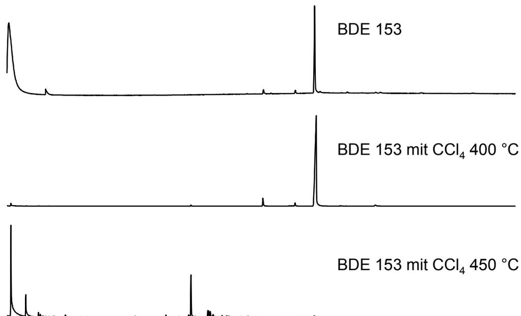
**Abbildung 90: Totalionenchromatogramme von BDE 153 und der Produkte aus den Pyrolysen BDE-153/ $\text{CCl}_4$ /400 °C und BDE-153/ $\text{CCl}_4$ /450 °C (Scan)**
