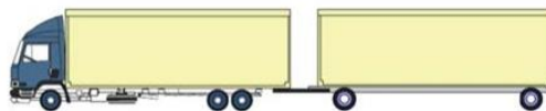
Typ 5: Lastkraftwagen mit einem Anhänger bis zu einer Gesamtlänge von 24,00 Metern (Bild: BAST)
