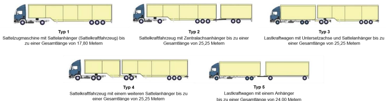
Abbildung 1: Übersicht über die im Rahmen des Feldversuchs zugelassenen Lang-Lkw-Typen nach [BASt Typ1-5]. Bilder: BASt.
