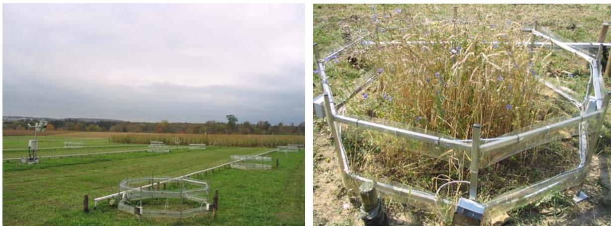
Abb. 1. Mini-FACE Experiment auf dem Versuchsgelände Heidfeldhof (Universität Hohenheim) im September 2005 (linkes Bild). Elevated-CO<sub>2</sub> Versuchsfläche kurz vor der Weizenernte im August 2004 (rechtes Bild).
