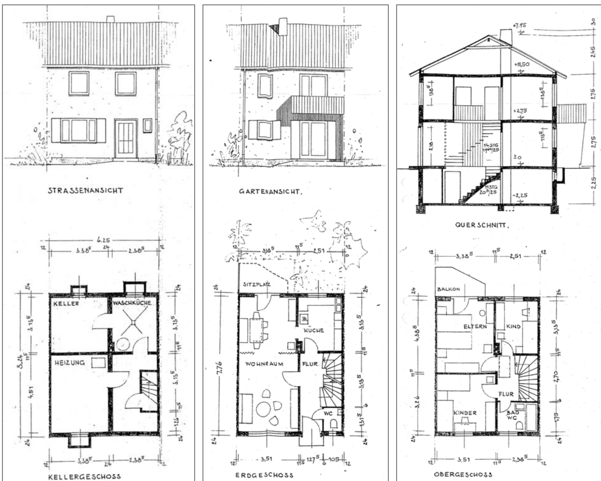
Abbildung 5.2-6-8. Grundrisse, Ansichten und Schnitt eines der typischen Reihenhäuser in der Siedlung. Man beachte den minimalen Zuschnitt vor allem der Kinderzimmer, ohne Maßstab, Quelle: Stadtverwaltung Marbach am Neckar
