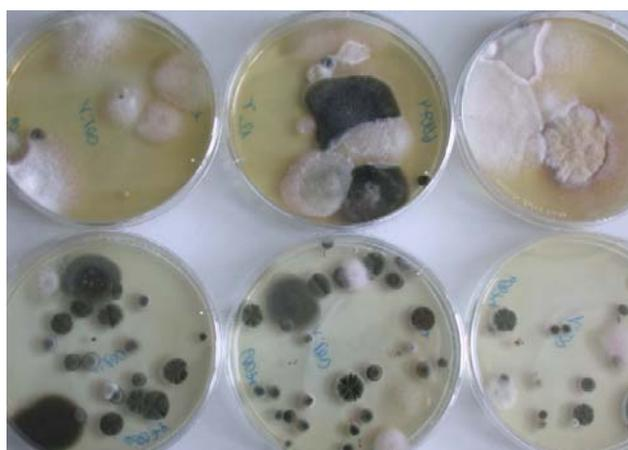
Juli: Verdünnung der Suspensionslösung 1:1000, drei parallel ausgestrichene Schalen. oben auf MEA, unten auf DG18
