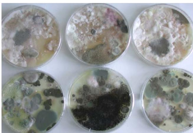
Juli: Verdünnung der Suspensionslösung 1:100, drei parallel ausgestrichene Schalen. oben auf MEA, unten auf DG18
