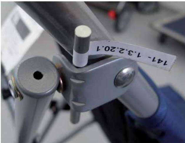
Abb. 11.3-2: Möglichkeit des Hängenbleibens zwischen Rahmenrohr und Winkelstück eines Kinderwagens, der Stift dient als „Modell“ eines Kinderfingers (LUBW, 2012).
