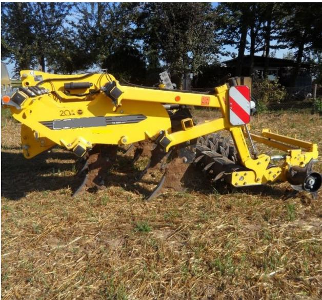
Abbildung 5.6: Wippscharlockerer zum Aufbrechen von Bodenverdichtungen bis zu 55 cm Tiefe (© Billen)
