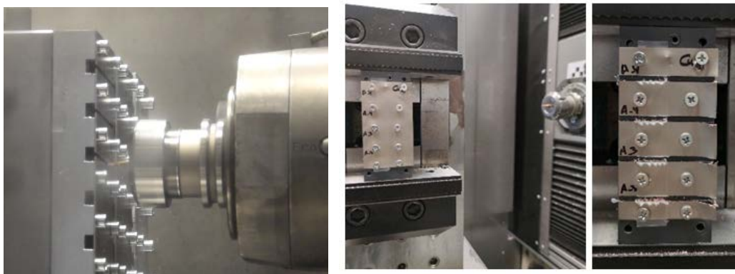
Abbildung 49: (links) Fräsen von Gehäuseblech aus Stahl, (rechts) Fräsen von Zell-Ableitertabs.
