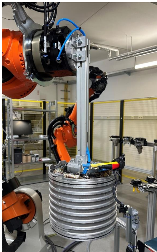
Abbildung 92: Demontierter Stator am Statorgreifer.
