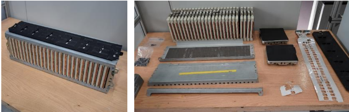
Abbildung 45: (links) Anlieferungszustand des Batteriemodul-Dummys PB320 (rechts) extrahierte Komponenten durch händische Demontage.
