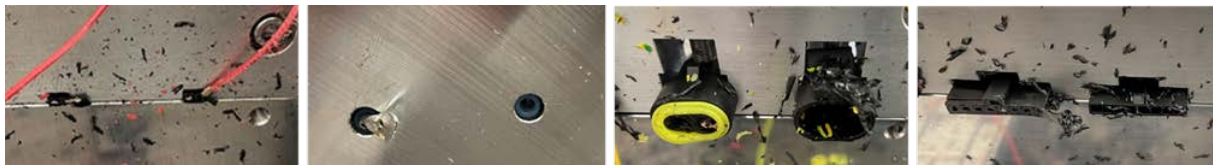
Abbildung 41: Trennversuche (v. l. n. r.) Tru Components Pre-fab braid Steckers; Cimco Flachstecker; AMP Super Seal; Molex Micro-Fit.
