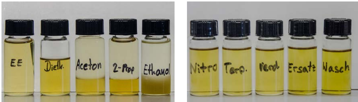
Abbildung 90: Löslichkeitsproben von Getriebeöl in verschiedenen Lösungsmitteln.
