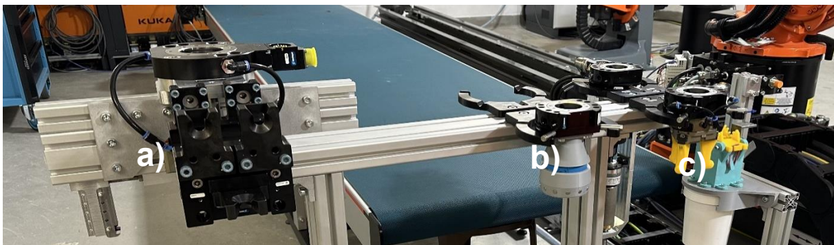
Abbildung 97: Werkzeugbahnhof, bestückt mit unterschiedlichen Werkzeugen. a) Greifer für Gehäusedeckel, b) Werkzeug zur Entnahme von Schrägwälzlagerschalen, c) Werkzeug zur Entnahme von Kugellagerschalen.
