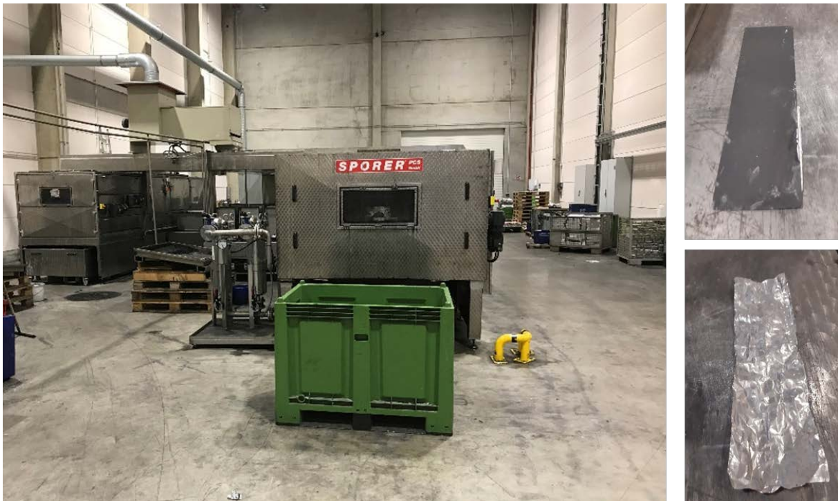
Abbildung 65: Überblick über die zweistraßige Leachinganlage bei ERLOS (links), Kathode im Urzustand (rechts oben) und Kathode nach der Entschichtung (rechts unten).
