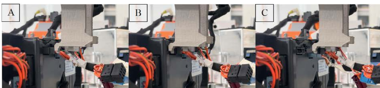
Abbildung 39: Beispielhafte Demontagesequenz eines Steckers ohne Widerhaken.
