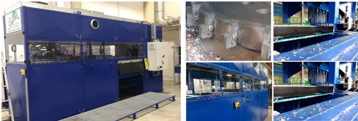
Abbildung 63: Links: Fräsanlage während der Installation, Rechts: Details zum Fräskopf, zur internen Transporteinheit und zum Ausdrückmechanismus.
