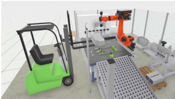
Abbildung 118: Virtuelle Anlage zur Demontage der Batteriemodule (IPA).
