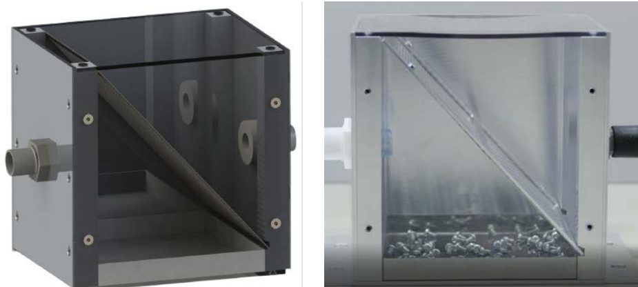
Abbildung 28: Abscheidevorrichtung für Schrauben: links, CAD-Modell; rechts: Prototyp.
