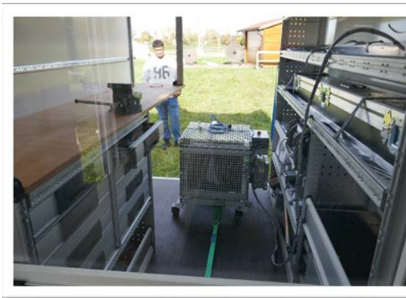
Abb. 6: Innenausbau des Logging-Trailers. Techniker Sam Rasamlingam ist mit dem Aufstellen der Winde zufrieden.
