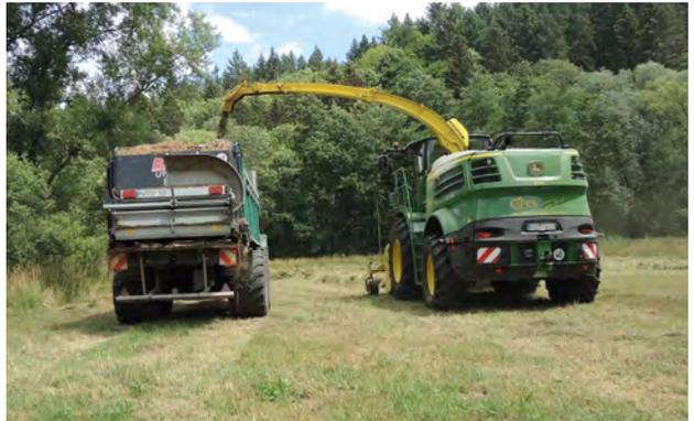
Eine weitere Möglichkeit ist die Aufnahme des geschwadeten Mahdgutes mit dem Feldhäcksler und Beladen des Miststreuers.
