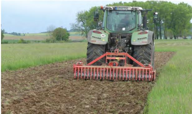
*Zweite Bodenbearbeitung mit der Kreiselegge. Die Soden sind nun bereits angetrocknet und zerfallen leicht.*
