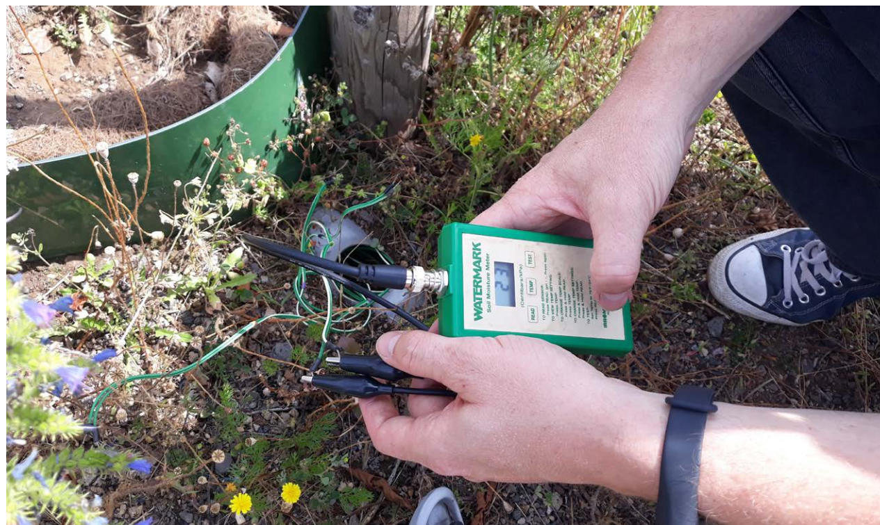
Abbildung 25: Bodenfeuchte-Messgerät im Einsatz, Bildnachweis (Foto: Christian Kotremba, LUBW)
