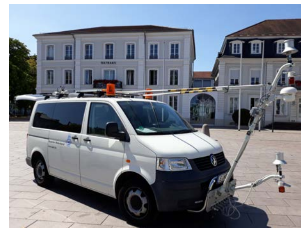
Abbildung 6: Messwagen des Deutschen Wetterdienstes mit Messapparatur (Foto: Christian Kotremba, LUBW)
