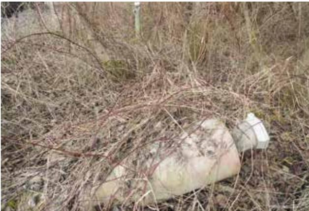
Abb. 6 Messstellen-Überprüfung: Zerstörtes Beobachtungsrohr
