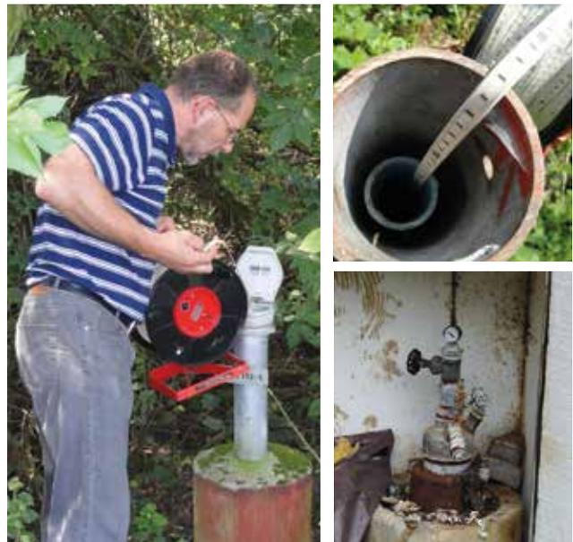
Abb. 1+2: Abstichmessung mit Kabellichtlot an der Messstelle in Schwarzach (Landkreis Rastatt)
