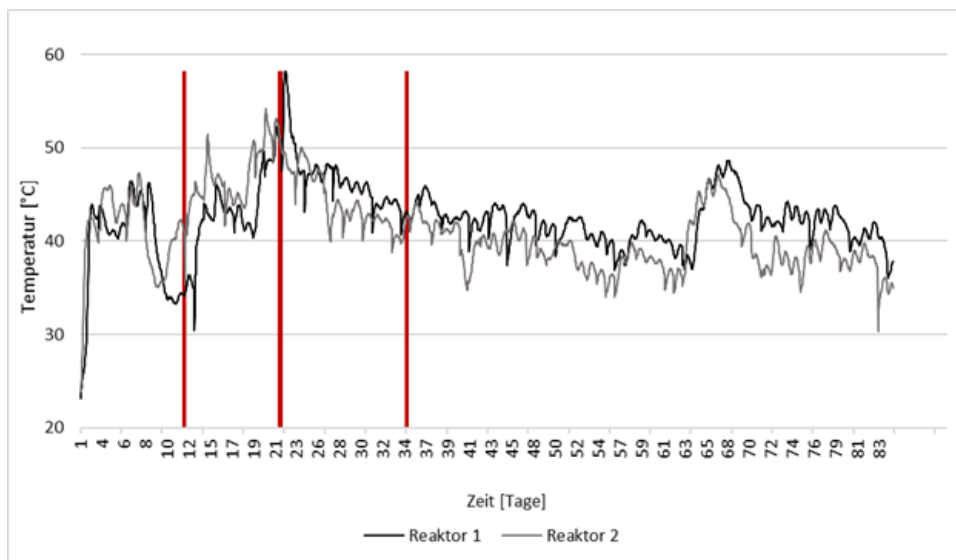
Abbildung 21: Temperaturkurve für die semi-dynamische Kompostierung in Versuchsreihe 2.
